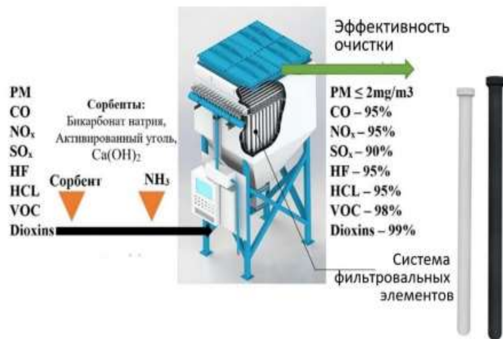
Общий вид керамического фильтра с указанием очищаемых компонентов из газового потока [1].
