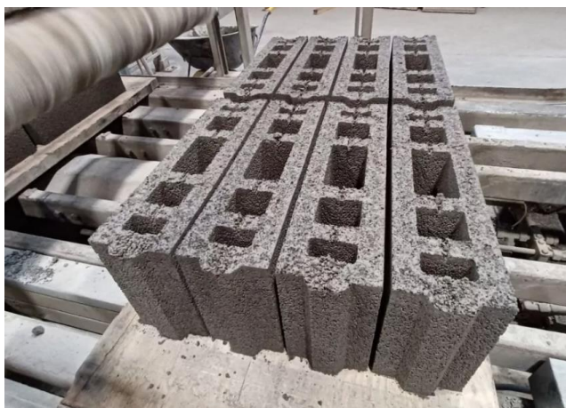
Рисунок 1. Блоки на производстве Carbstone Innovation. Источник: https://www.carbstone.be/ .
